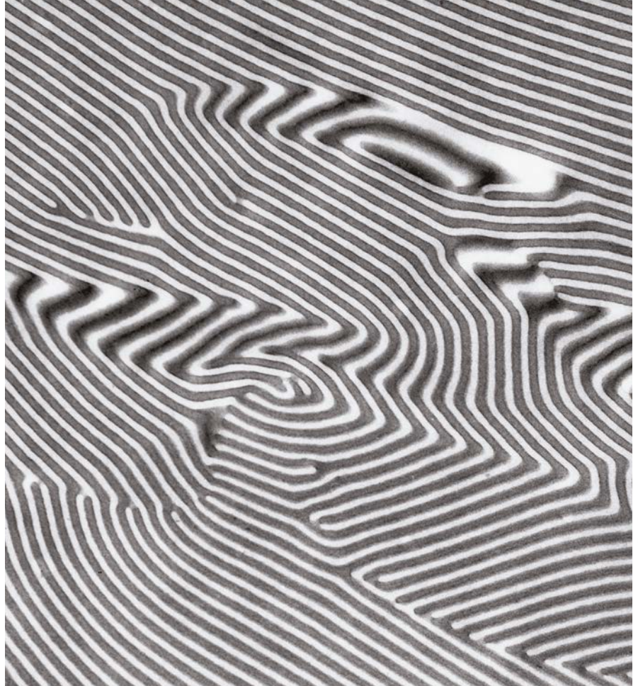
▲ Styrene-butadiene block copolymer x 25'000 Ronald Walter, BASF Aktiengesellschaft, Polymer Physics, D-67056 Ludwigshafen.
